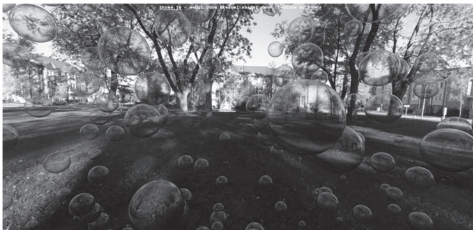
Rysunek 4.14. Shader Fresnela pozwala uzyskać realistyczne efekty dzięki odbiciu i załamaniu światła
