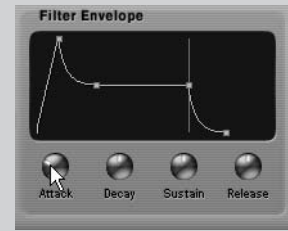
Rysunek 13.4. Poruszenie pokrętłem Attack przy włączonym przycisku Write Automation i uruchomionym odtwarzaniu powoduje zapisywanie zmian tego parametru w czasie
