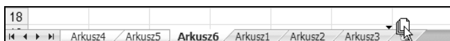
Rysunek 3.12. Przed trzema zaznaczonymi zostały wstawione trzy nowe arkusze. Po zaznaczeniu można je jednocześnie przesunąć na koniec
