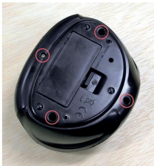
Rysunek 7.5. W celu otwarcia obudowy zegara należy odkręcić wszystkie cztery śruby oznaczone kółkami
