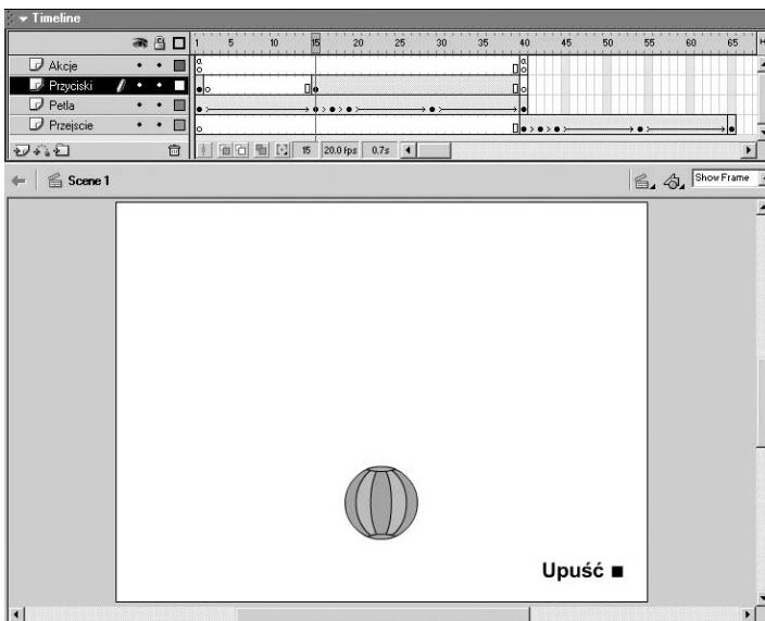
Rysunek 3.6. Przycisk „Upusc” oraz parametry przypisanej mu akcji goto (Flash MX)
