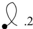
Rysunek 3.3. Ciąg graffiti potrzebny do włączenia trybu debugowania komputera Palm (tzw. skrót kropka kropka dwa — ang. shortcut dot dot two)
