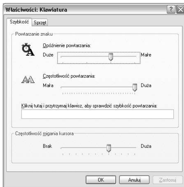
Rysunek 1.3. Właściwe ustawienia opóźnienia i częstotliwości autopowtarzania pomagają rozwiązać większość problemów związanych z powielaniem i (lub) gubieniem liter
