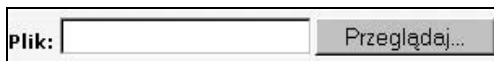
Rysunek 11.16. Definicja typu file tworzy na formularzu zawartym na stronie HTML przycisk podobny do pokazanego powyżej
