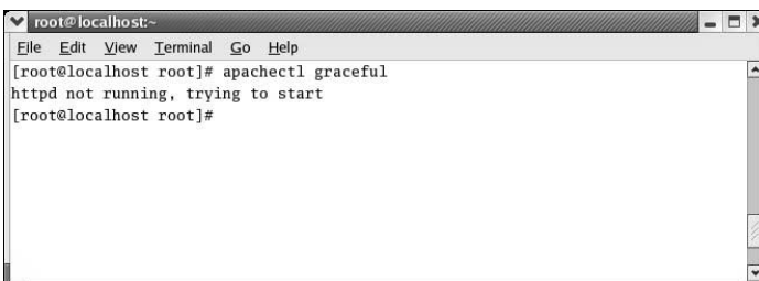
Rysunek 11.18. Aby zmiany dokonane w pliku konfiguracyjnym języka PHP zostały uwzględnione, konieczne jest ponowne uruchomienie serwera WWW
