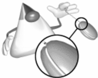
Rys. A.11. Roztrzaskanie kolorów (dithering) pozwala zamaskować paski przez wymieszanie ze sobą pikseli z przylegających obszarów
