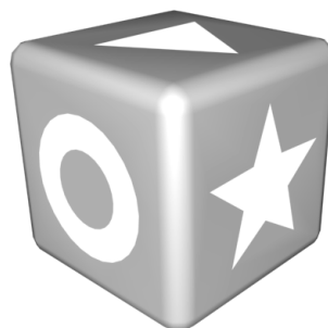
Rysunek 10.28. Opcja Cookie Cutter wycina w obiekcie siatkowym otwory odpowiadające zagnieżdżonym kształtom
