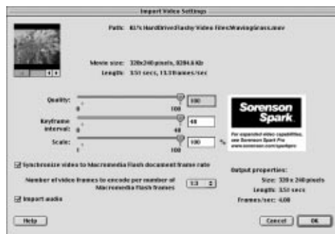
Rysunek 14.50. Okno dialogowe Import Video Settings jest interfejsem kodeka Sorenson Media's Spark. Zakoduje on i skompresuje importowany plik wideo. Skorzystaj z opcji okna Import Video Settings , aby uzyskać rozsądny kompromis między rozmiarem pliku a jakością filmu
