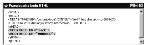
Rysunek 11.12. Bez względu na użyty sposób zapisu ta przykładowa strona będzie miała czarny kolor tła
