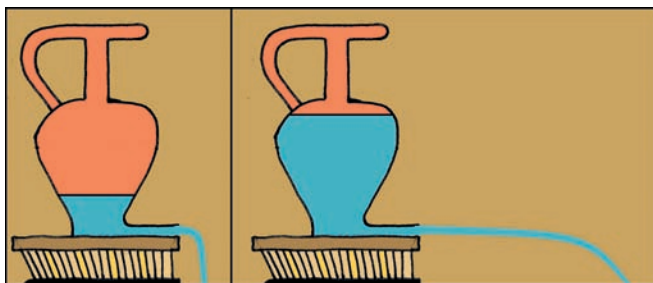
Rysunek 2.19. Przy niskim stanie wody w amforze (z lewej) woda ledwie ciec, natomiast wysoki jej stan w amforze (z prawej) wywołuje duży strumień
