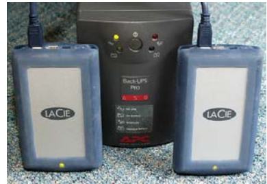
Rysunek 8.14. Podręczne dyski twarde FireWire (IEEE1394) o pojemności 30 GB firmy LaCie wraz z UPS-em Back-UPS Pro
