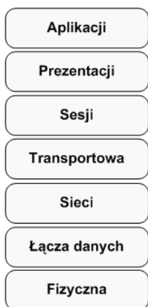
Rysunek 16.11. Model warstwowy OSI
