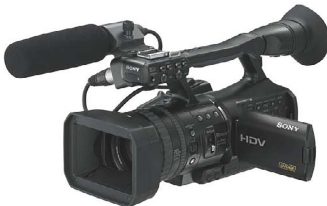
RYSUNEK 1.12. Kamera Sony HVR-A1U z klasy prosumenckiej jest wyposażona w profesjonalne wejścia mikrofonowe z zasilaniem fantomowym oraz ręczne regulatory ostrości i czasu ekspozycji, lecz wiele opcji jest dostępnych tylko z jej ekranu dotykowego
