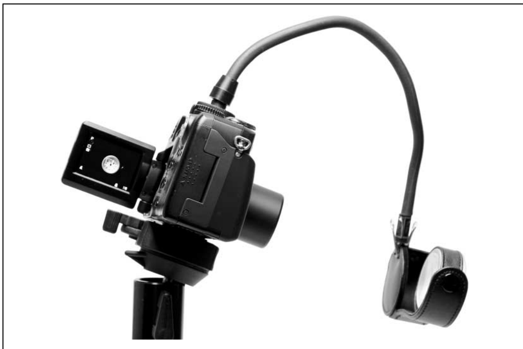
Rysunek 1.8. Elastyczny wysięgnik Flare Buster przytrzymujący fotografowany obiekt
