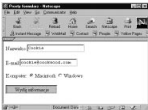
Rys. 11.3. Kiedy użytkownik wprowadzi informacje do pól tekstowych i wybierze przycisk radiowy, pary nazwa-wartość są gotowe. Kliknięcie przycisku dostarczającego (nazwany tu Wyślij informacje) prześle pary nazwa-wartość do skryptu CGI na serwerze
