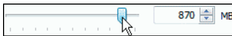
Rysunek 6.22. Przesuwając suwak, można określić, ile miejsca na dysku flash zarezerwowane zostanie dla usługi ReadyBoost
