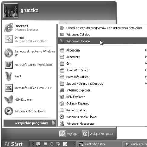
Rysunek 2.17. Aby skorzystać z mechanizmu Windows Update, kliknij przycisk Start i w menu Wszystkie programy wybierz Windows Update
